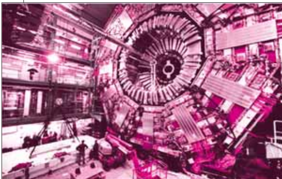
▲ شکل ۲. CMS به ابعاد ۱۵ متر در ۱۵ متر در ۲۵ متر و جرم ۱۴۰۰۰ تن یکی از چهار آشکارساز سرن است که افتخار آشکارسازی هیگز را در کارنامه دارد.
